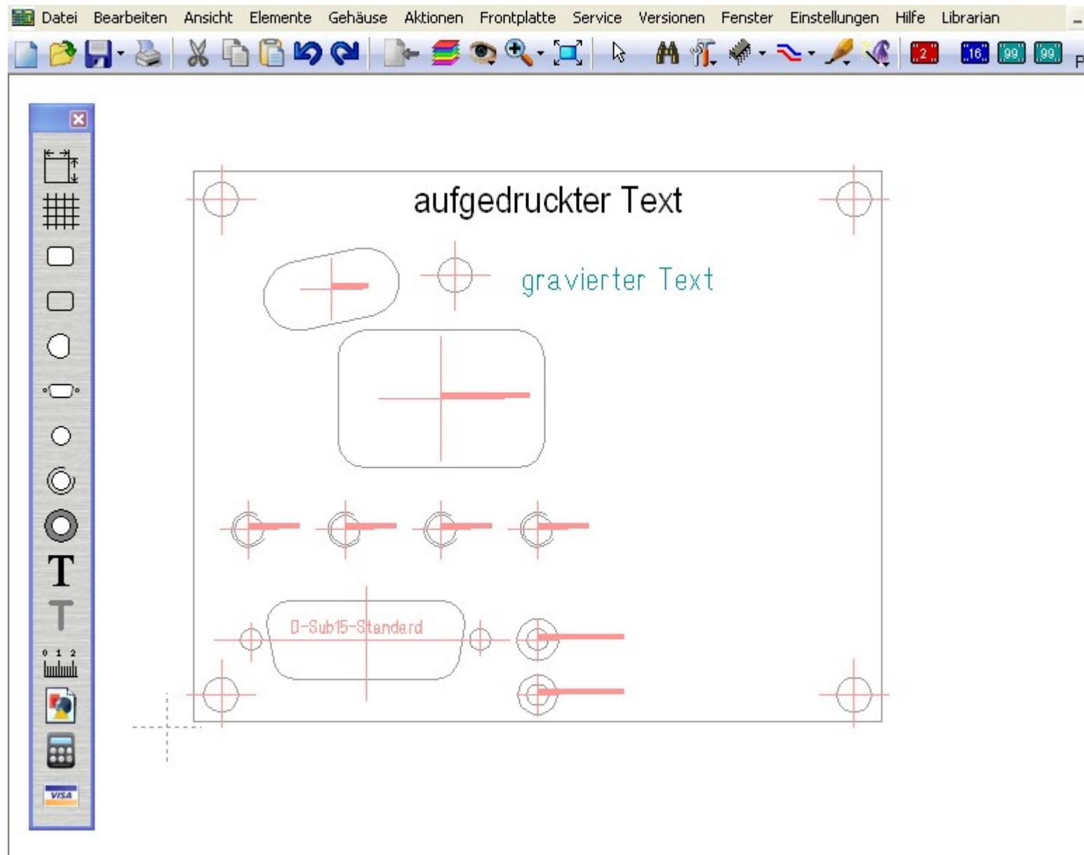
Gravierter Text, realisiert auf Ebene 34, Frontplatte (Gravieren)
