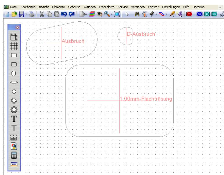
D-Ausbruch mit 5 mm Durchmesser und Breite von 4 mm (oben rechts).
