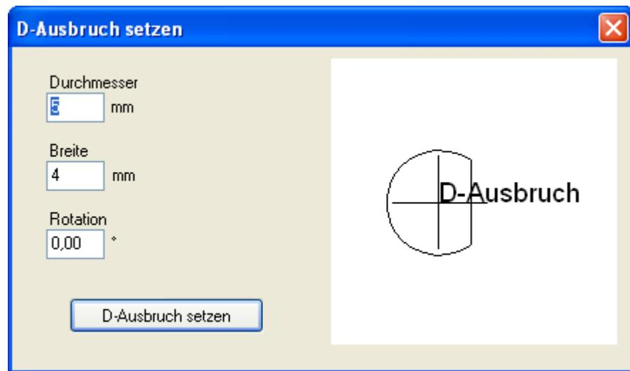
Der Dialog zur Bestimmung eines D-Ausbruchs
